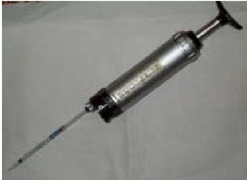
図1 各種の測定機材 検知管
