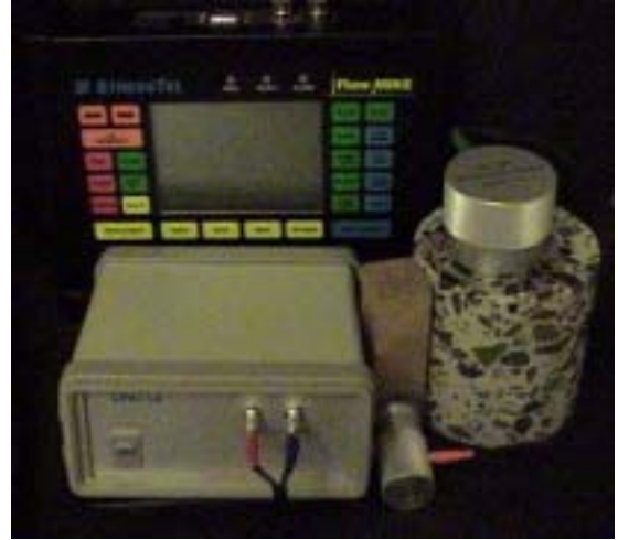
市販探傷器、アダプターFLA11と探触子 (弊社取扱米国 Stresstel 社製 FlawMike)
