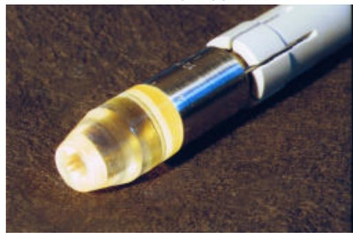
いずれの探触子も1-3型コンポジット振動子を用いています。1-3コンポジット型振動子は感度余裕が高く、小さな欠陥の検出や外来ノイズ環境の悪い場所での検査に向きます。探傷器側の周波数レンジを選ぶ事に依って、2~10MHzの探触子として仕様することができます。
